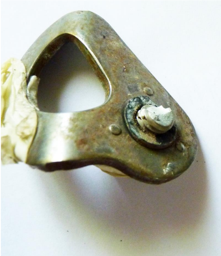
Φωτογραφία 2 η : το βύσμα από την Rock & Roll (δοκιμή θραύσης το 2015)
